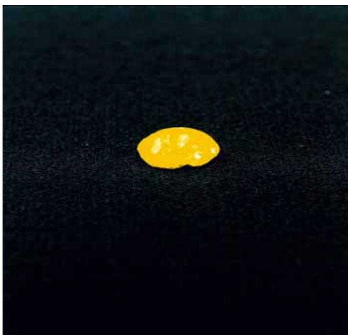
< Photo.16 > : 水中に注入後、5分以上経過した『Karton Nr』。黄色にゲル化しており、かなり堅い。
